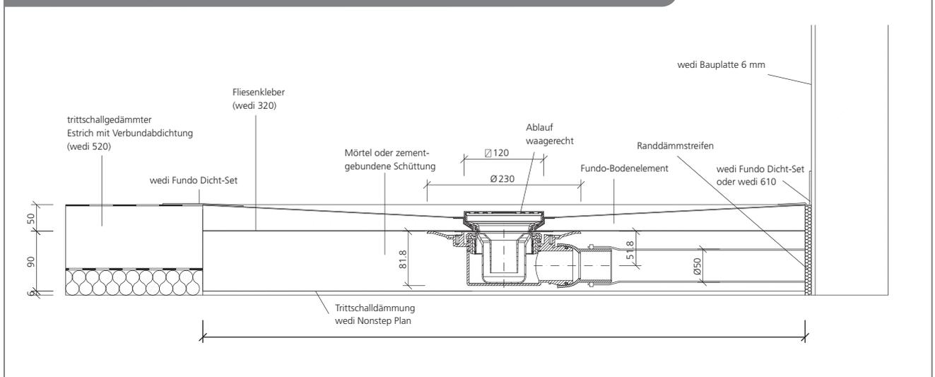
Fundo Ablauf senkrecht, DN 50, Estrichfußboden (auch mit Feuerstopp und DN 70 erhältlich)
