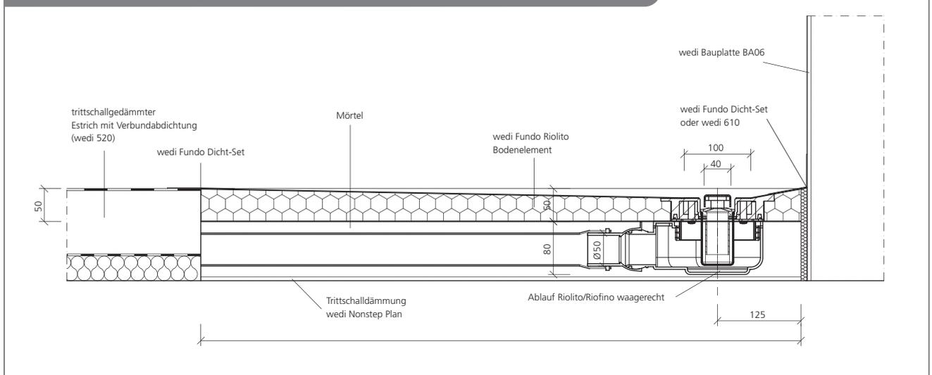
Fundo Ablauf Riolito senkrecht, DN 50, Estrichfußboden (auch mit Feuerstopp erhältlich)
